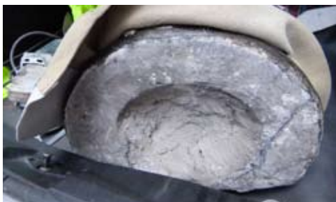
De cartouche op de voetplaat (foto boven) en de holte aan de onderkant met mortelopvulling (foto onder)
